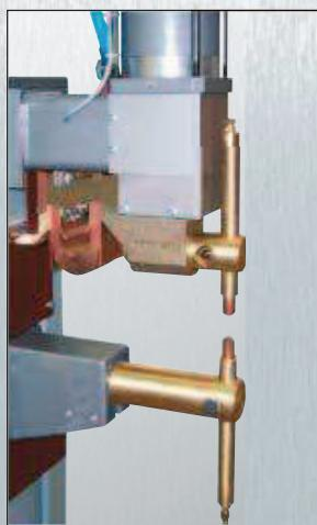
Plynule nastavitelné vyložení
