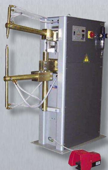
SL 206 s kyvným ramenem pro svařování obtížně přístupných míst: držák elektrody na kyvném rameni je axiálně nastavitelný, spodní držák elektrody radiálně a výškově nastavitelný.
