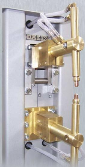
Série SF/SL 200 s inovovanou AFS-Technikou (Anti-Friction-System). AFS umožňuje dosednutí elektrody bez tření, díky tomu je docílen přesný a bezztrátový přenos přítlacné síly na svařovaný materiál.
