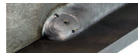
S plněním koncového kráteru – perfektní konec svaru
